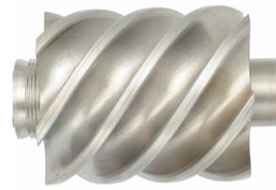
Mobil SHC™ Ragus после 2640 часов испытаний
