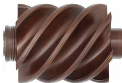
Синтетические компрессорные масла после 1325 часов испытаний
